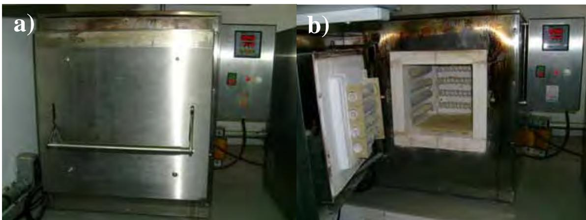
**Figura 3.1.** Forno utilizado para a calcinação do precursor da fase cerâmica KSN. a) Forno fechado e b) Forno aberto.
