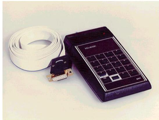
Figura 2.5. O Telidon, sistema de videotexto canadense.<sup>6</sup>
