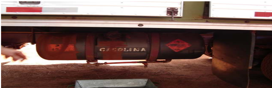
Figura 29 Detalhe do compartimento de gasolina do caminhão baú
