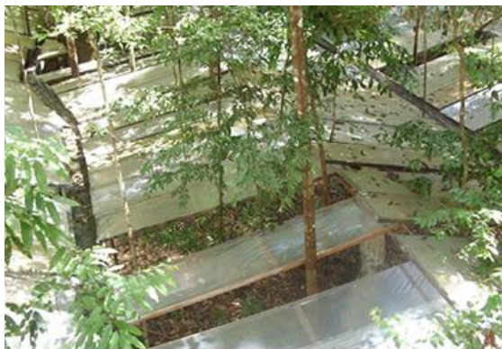
Painéis de plástico cobrem o hectare experimental dificultando a penetração da água da chuva no solo. (Foto: Leandro Ferreira).
