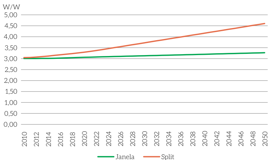
Figura 80 – COP Representativo dos Equipamentos de Ar-condicionado por Tecnologia (2010-2050)
