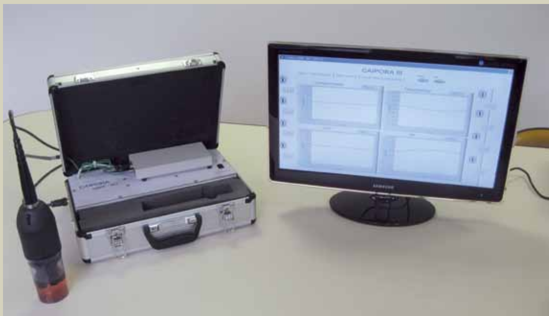
Figura 2: “Caipora” - Registrador Multipropósito Modular para Monitoramento Remoto Ambiental.
