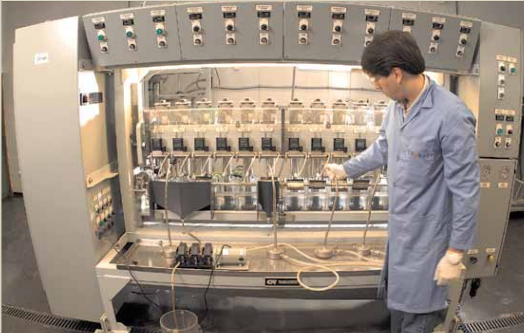
Fig. 4: Mini-usina de Flotação Instrumentada
