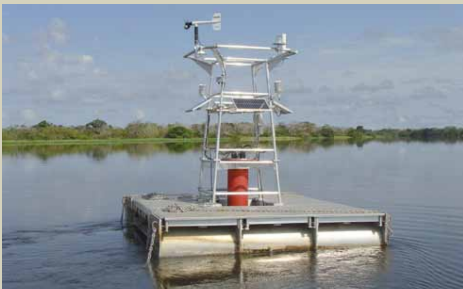
Foto 3: Equipamento de pesquisa do convênio INPE/Mamirauá para monitoramento da água, via satélite.
