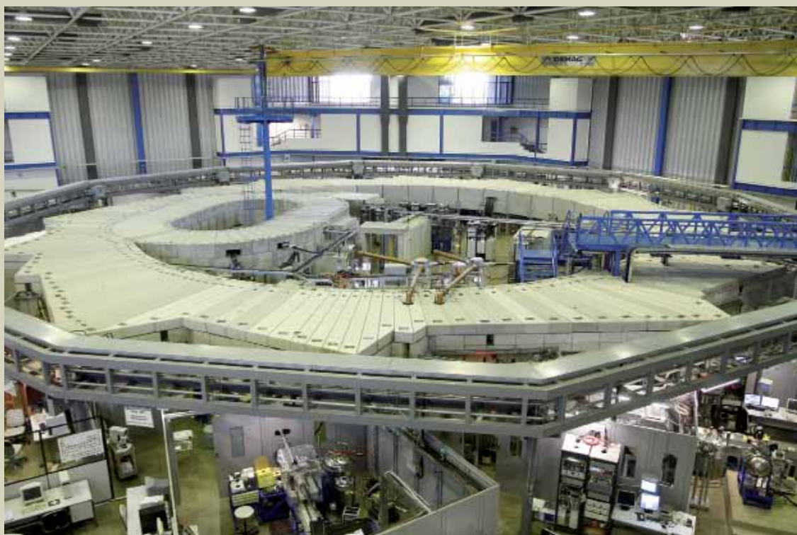
Foto 4: A única fonte de luz síncrotron da América Latina gera radiações eletromagnéticas que vão do ultravioleta até a faixa de raios-X moles.
