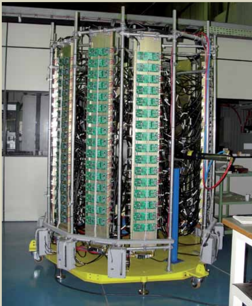
Foto 1. Amplificador em Estado Sólido reduzirá o consumo de energia elétrica e a complexidade de manutenção devido à sua construção modular
