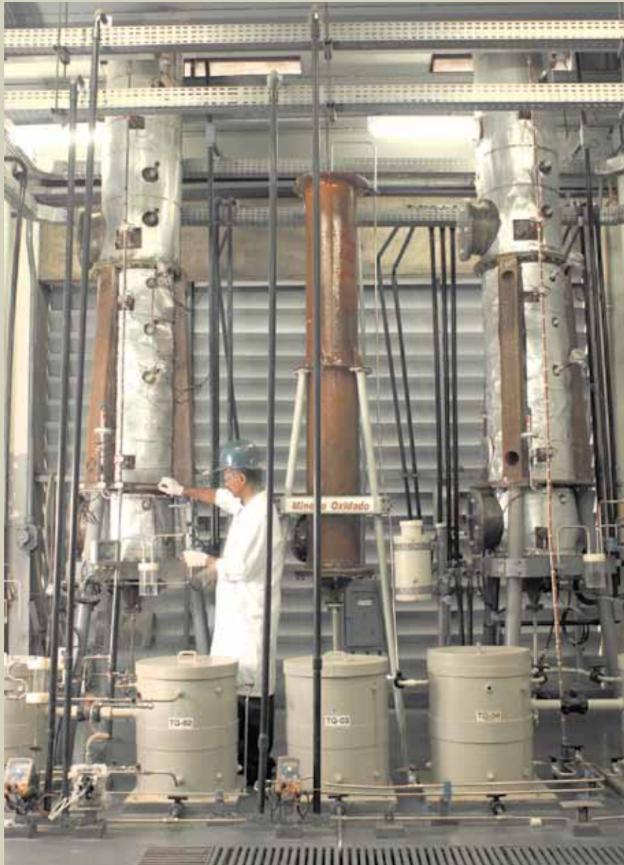
Fig. 8: Unidade-piloto para biolixiviação em pilha de minérios com baixo teor de cobre.
