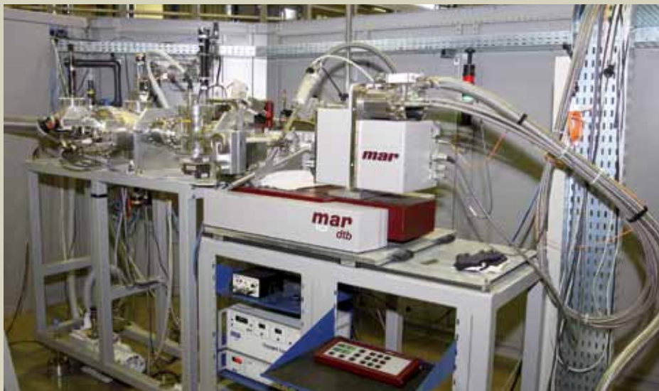
Foto 5: MX2 – A primeira linha de Luz do LNLs alimentada por um dispositivo de inserção – wiggler híbrido multipolar de 2,0 Tesla
