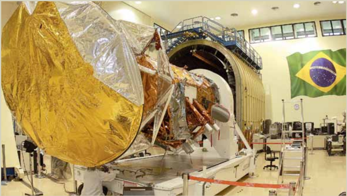
Foto 2: O satélite SAC-D em teste no LIT/INPE
