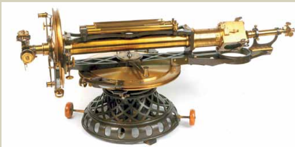
Foto 3: Altazimuth Prismático, instrumento para observação astronômica, produzido no Brasil no final do Século XIX e pertencente à coleção do MAST
