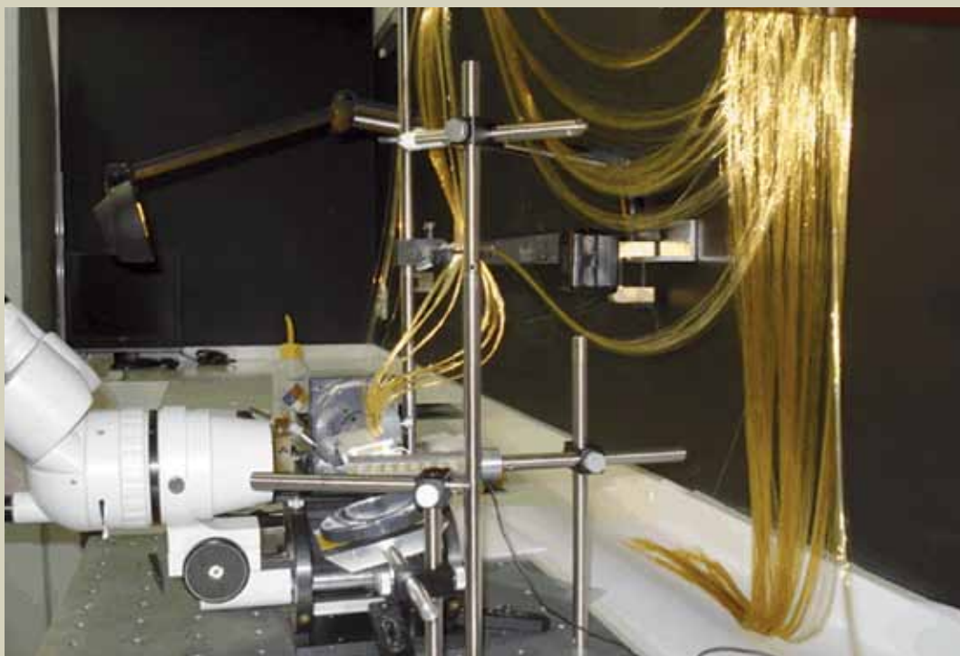
Figura 3: “1300 fibras óticas usadas no espectrógrafo SIFS para o Telescópio SOAR”
