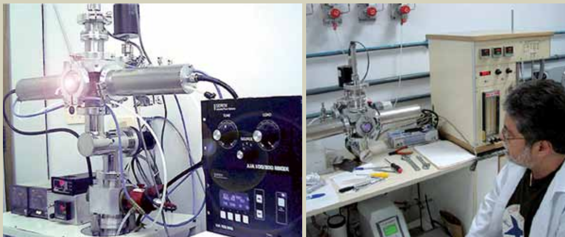
Figura 27: Sistema para Recobrimentos de Cerâmicas biocompatíveis de hidroxiapatita cristalina e nanoestruturada por Dual Magnetron sputtering, desenvolvido inteiramente no CBPF.
