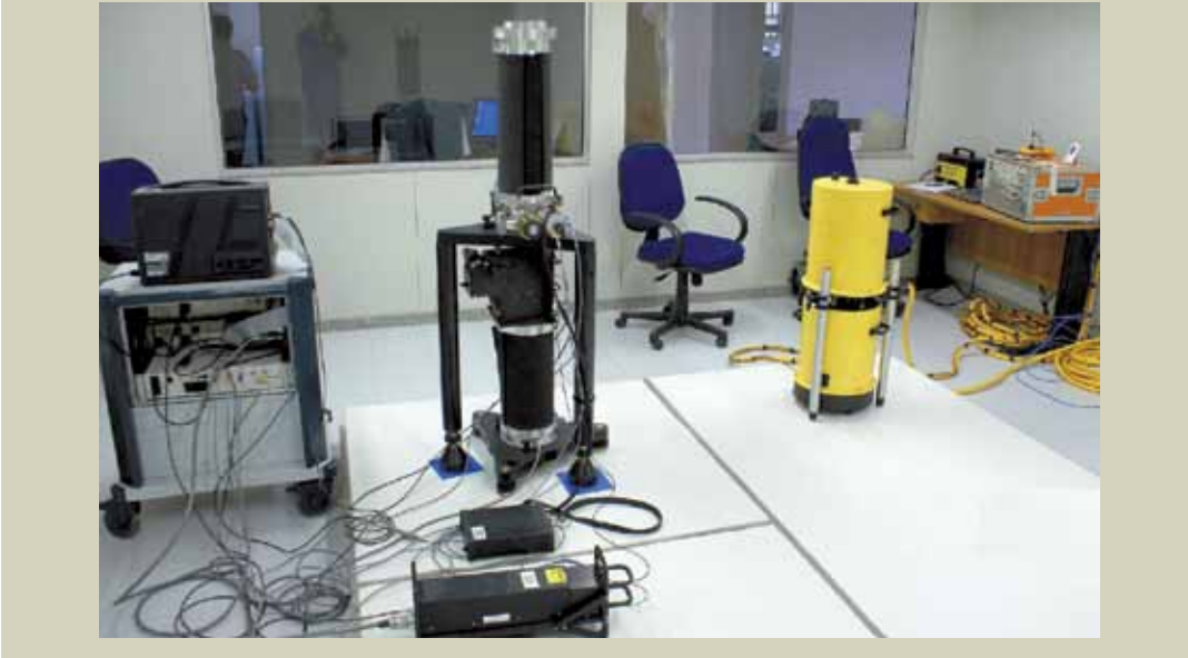
Foto 7 – Laboratório de Gravimetria, em Vassouras (RJ). A foto mostra dois gravímetros absolutos, os primeiros da América Latina.
