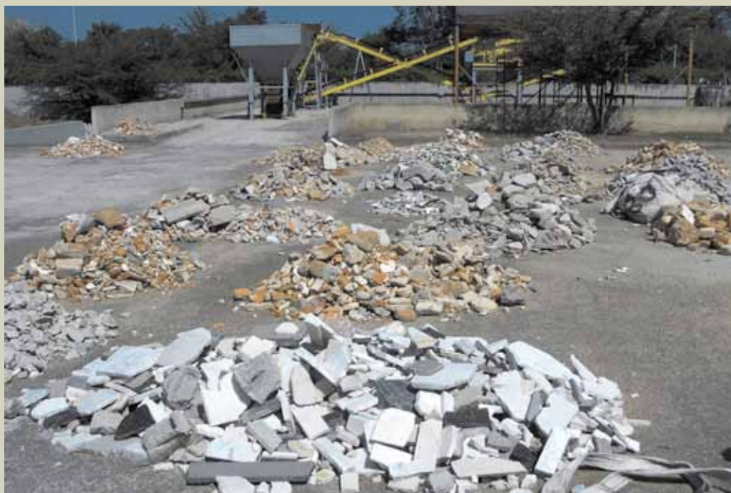
Fig. 5: Usina-piloto para reciclagem de resíduo da construção civil
