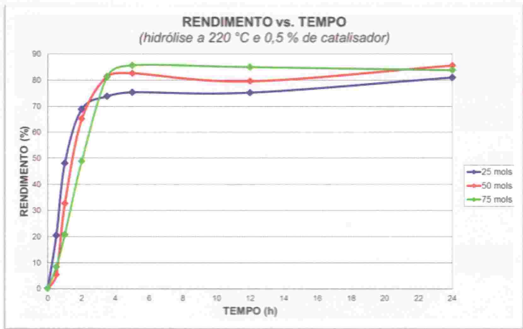
Figura 3.20. Variação do Rendimento em função do tempo de reação na Hidrólise de óleo de soja. Curvas para 25, 50 e 75 mols de água a 220 °C e na presença de 0,5 % de (\text{SnO}_2)_2(\text{Al}_2\text{O}_3)_8 . / Fonte: Os autores (2015).
