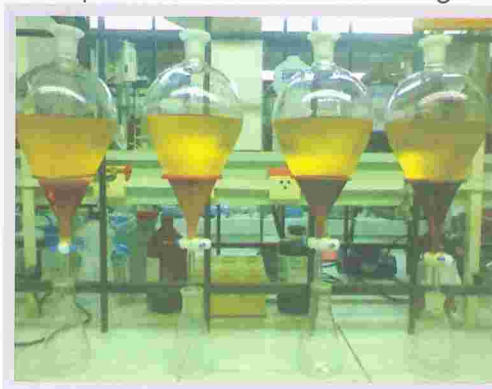
Figura 2.3. Etapa de separação dos produtos da reação de transesterificação do óleo de soja com álcool metílico. / Fonte: Os autores (2015).
