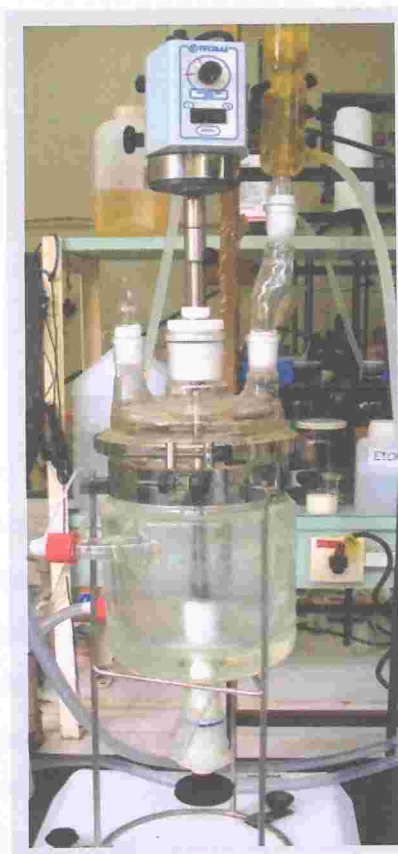
Figura 2.1. Reator de vidro empregado nas reações de transesterificação.
