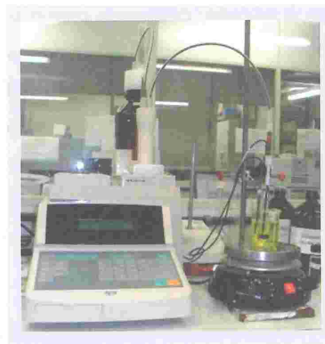
Figura 2.8. Titulador potenciométrico adotado para determinar o índice de acidez do biodiesel.
