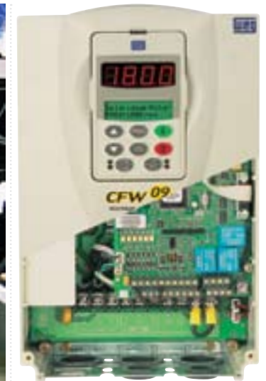
Inversor de frequência (acima) e linha de montagem: complementaridade entre pesquisa acadêmica e aplicada
