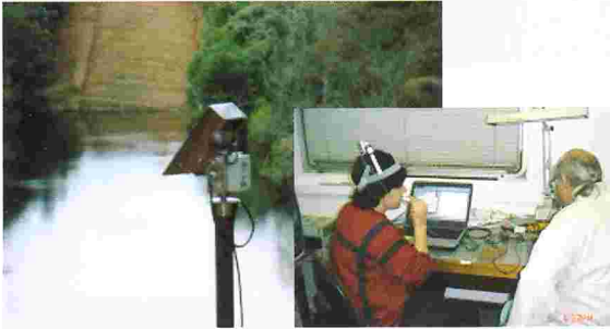
Esquerda: Sistema sensorial utilizado em monitoramento ambiental para medida de erosão. Direita: plataforma sensorial do projeto AUXILIS.
