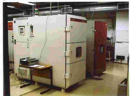
Ensaio climático e de confiabilidade de produtos eletrônicos (câmaras climática e de reciclagem térmica).
