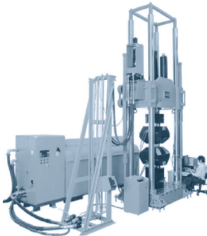
Figura 16 – Equipamento para teste estático e de fadiga de corpos de prova grandes até 2.500 kN.
