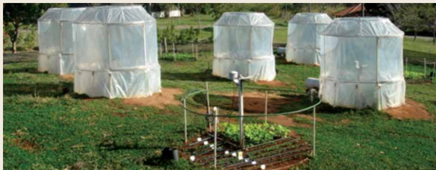
Estufas de topo aberto utilizadas nos estudos de impactos de mudanças climáticas e doenças de plantas, na Embrapa Meio Ambiente.
