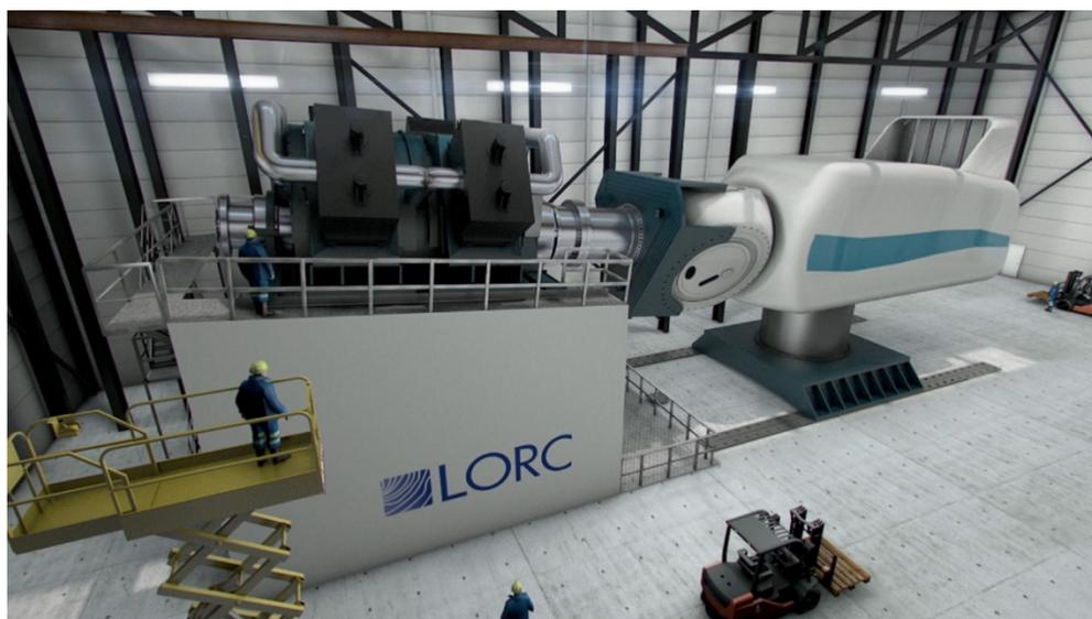
Figura 6. Ilustração do laboratório de teste de naceles que está em construção na Dinamarca.
