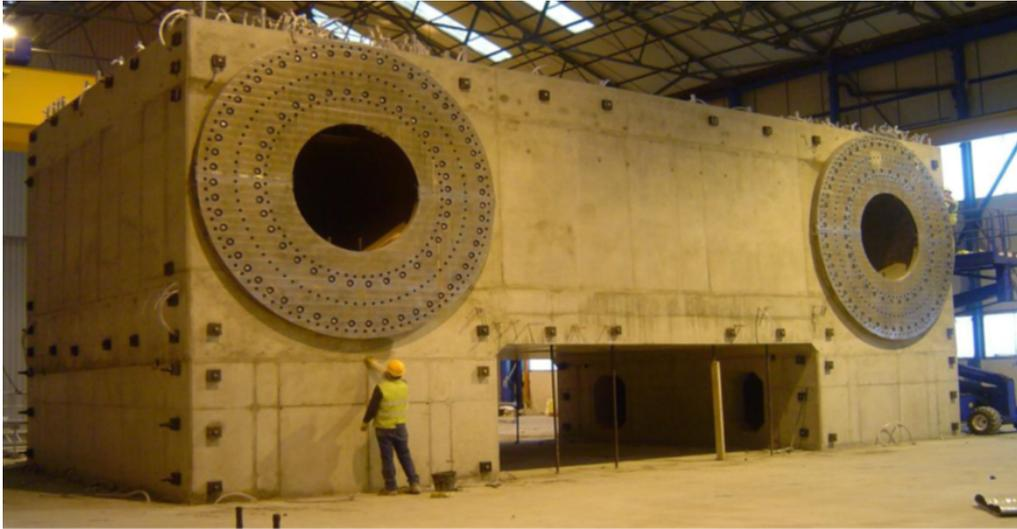
*Figura 9 - Exemplo de bloco de ancoragem para teste de pás de aerogerador.
