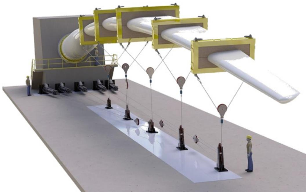
Figura 7 - Ilustração do teste estático para pás de aerogerador.
