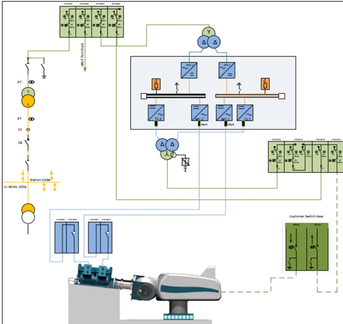
Figura 12 - Exemplo de diagrama unifilar para simulação de rede elétrica em bancada de testes de naceles completas. Fonte: LORC, 2014
