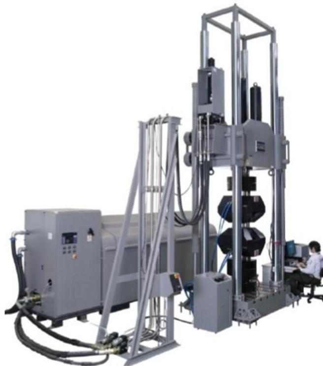
*Figura 16 - Equipamento para teste estático e de fadiga de corpos de prova grandes até 2500kN. Fonte : MTS, 2014.*
