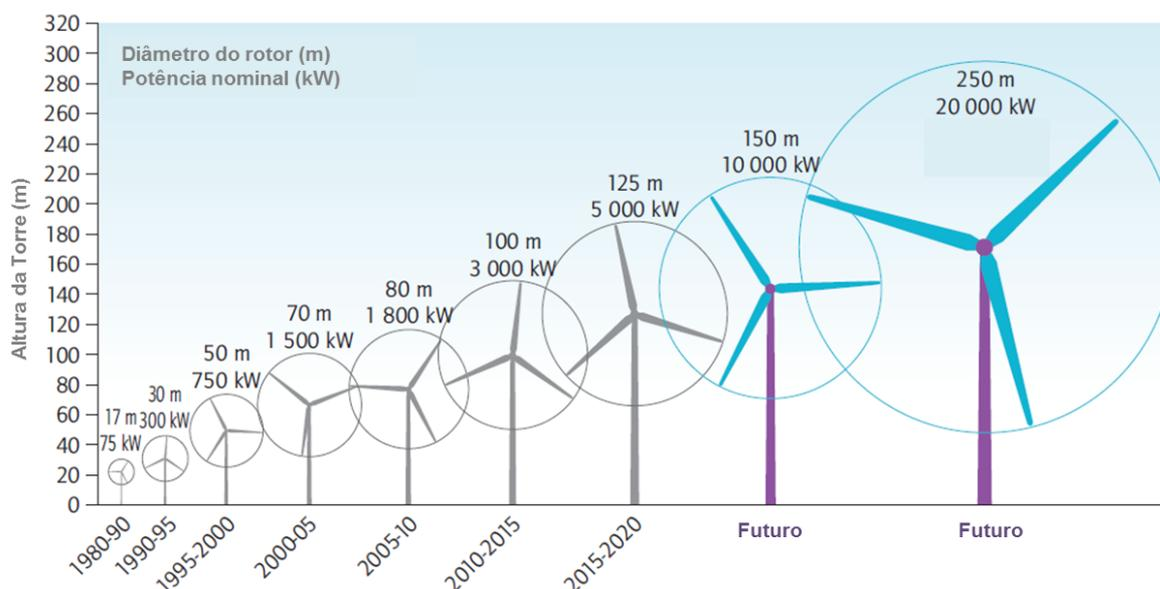
Figura 1 – Crescimento dos aerogeradores – diâmetro do rotor, altura de torre e potência nominal.
