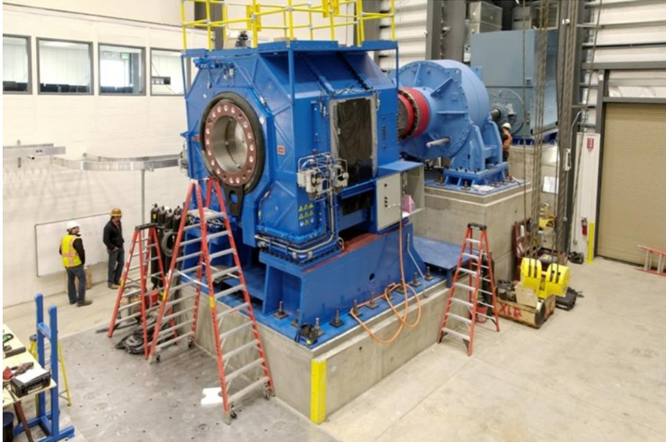
Figura 9. Laboratório de teste de naceles e multiplicadores de velocidade (Dynamometer Test Facility).
