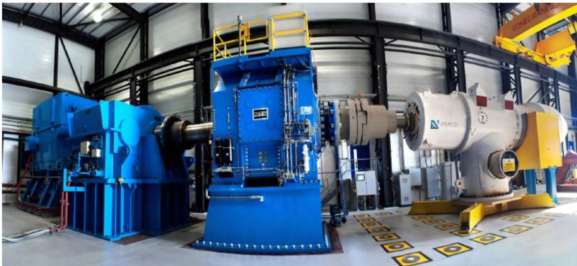
Figura 8. Laboratório de teste de naceles com capacidade para até 3MW.
