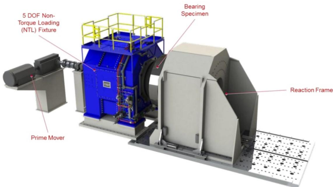
Figura 13 - Ilustração de uma bancada para teste de rolamentos principais (baixa rotação). Fonte : MTS, 2014.
