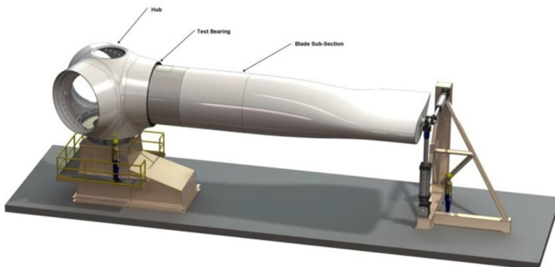
Figura 14 - Ilustração de uma bancada para teste de rolamentos de pitch.
