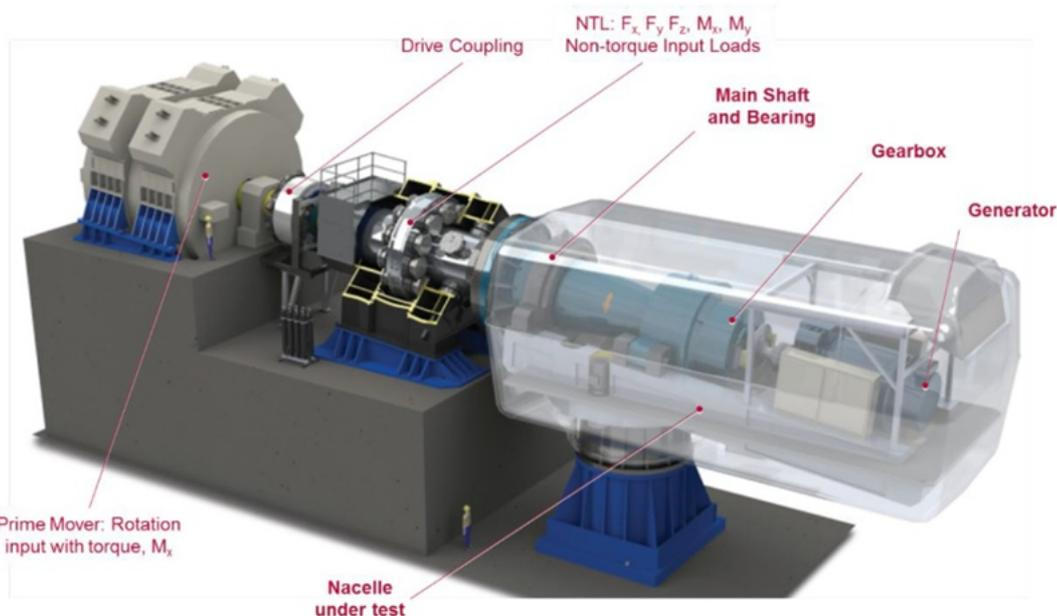
Figura 10 - Exemplo de bancada para teste de multiplicadores de velocidade e de nacelas completas.
