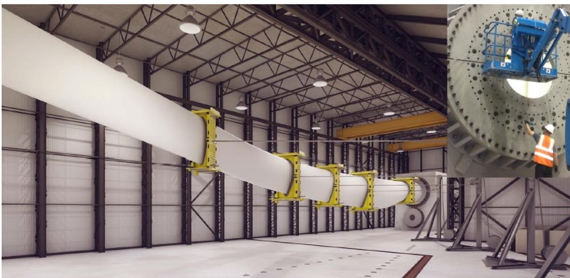
*Figura 7. Laboratório de teste de pás com comprimento de até 100m.
