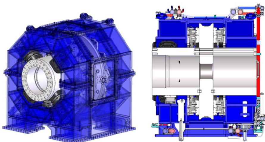
Figura 11 - Ilustração de uma máquina NTL para aplicação de forças e momentos em um eixo girante.
