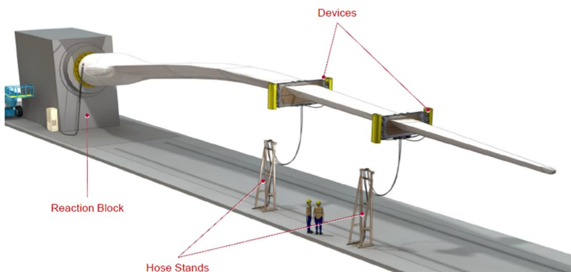
Figura 8 - Ilustração do teste de fadiga para pás de aerogerador .
