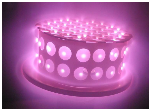
Tratamento de superfície metálica por plasma de nitrogênio
