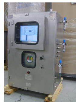
Analizador de processo baseado em Espectroscopia no Infravermelho Pr ximo (NIR) para monitoramento de hidrocarbonetos derivados do petr leo
