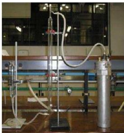
Figura 5 - Sistema de medida da pressão interna dos frascos de estocagem das amostras de carvão, conectado a um canister metálico.
