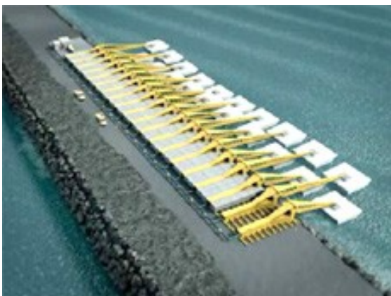
Projeto conceitual de sistema de geração por ondas, CoppeUFRJ a ser instalado no Porto de pecem – Ceará.
