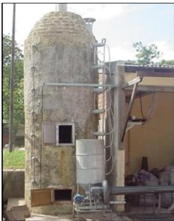
Combustor ciclônico para serragem desenvolvido pela UFPA com recursos de edital destinado a Rede Nacional de Combustão
