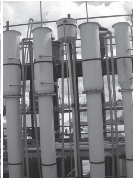
Figura 11.11 Reatores híbridos (UASB + filtros biológicos)
