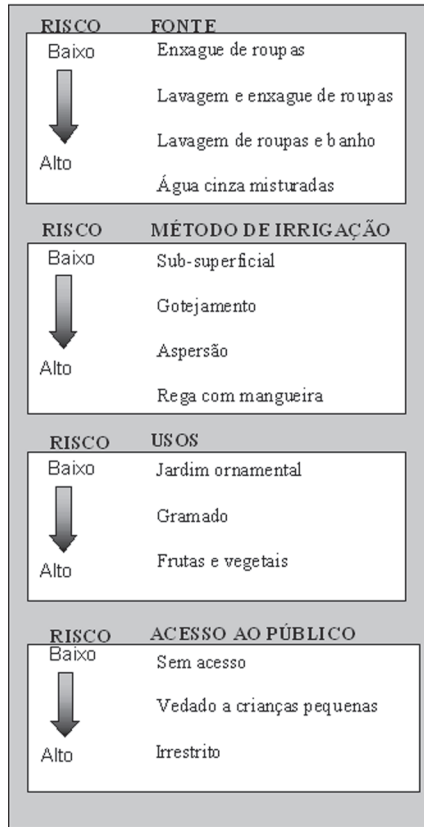
Figura 4.4 Riscos relativos associados à fonte de água cinza, aos métodos de irrigação, aos usos e ao acesso ao público. (Fonte: EACT, 2006)
