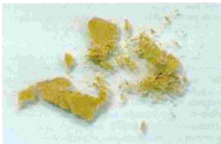
Figura 136: Material pastoso proveniente do biodiesel que se deposita e obstrui filtros de combustível
