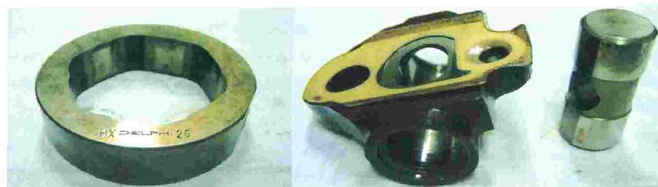
Figura 17: Bomba rotativa Delphi, trator Valtra – Anel de ressaltos e caixa de avanço
