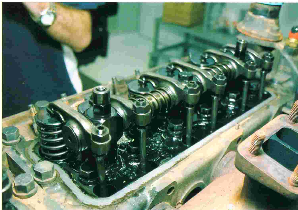
Figura 14: Eixo dos balanceiros em estado normal
