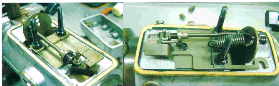
Figura 16: Bomba rotativa Delphi, trator Valtra – região interna do cabeçote hidráulico
