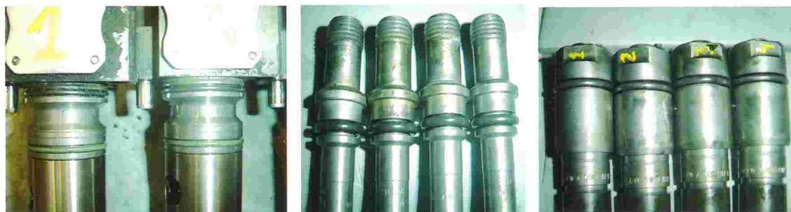
Figura 32: Anéis o'ring da Unidade injetora, do tubo de alta pressão e dos bicos injetores
