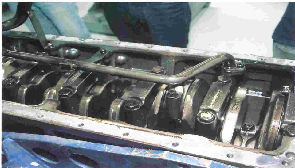
Figura 13: Mancais do bloco do motor e árvore de manivelas normais e sem danos
