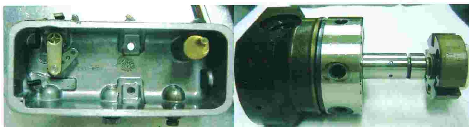
Figura 16: Bomba rotativa Delphi, trator Valtra – região interna do cabeçote hidráulico
