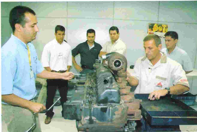
Figura 11: Desmontagem do motor Sisu Diesel testado com B20 Soja na sede da Valtra
