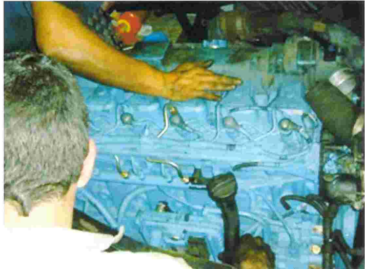
Figura 69: Reinstalação do motor MWM 6.12 TCAE no ônibus da Real Auto-Ônibus
