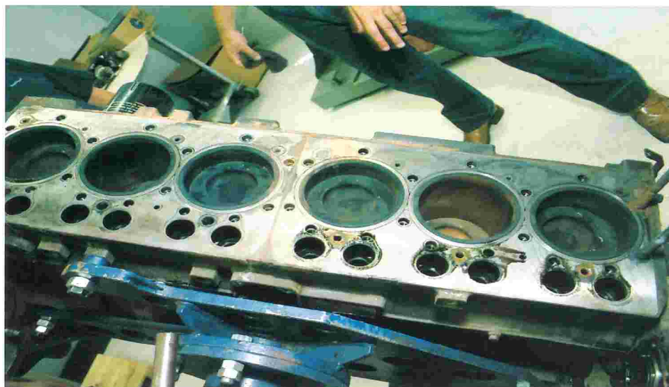
Figura 12: Bloco do motor sem danos
