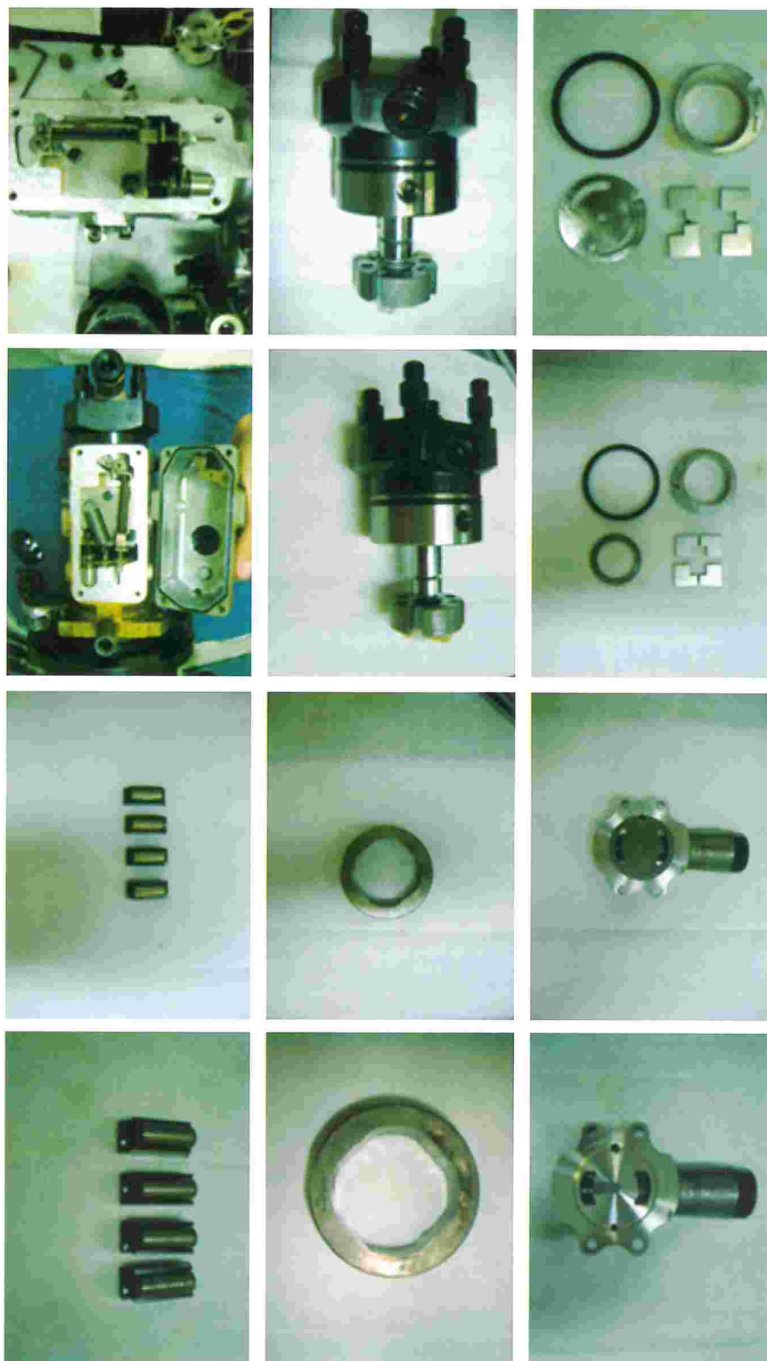
Figura 149: Aspecto das peças da bomba injetora antes e depois do ensaio
