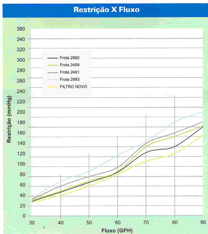
Figura 88: Restrição de fluxo nos filtros de combustível
