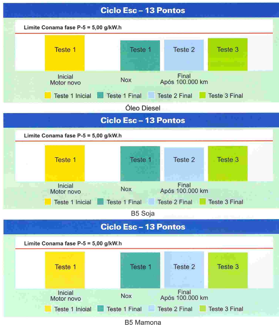
Figura 98: Emissões de NOx (Diesel X B5 Soja X B5 Mamona) antes e após 100.000 km
