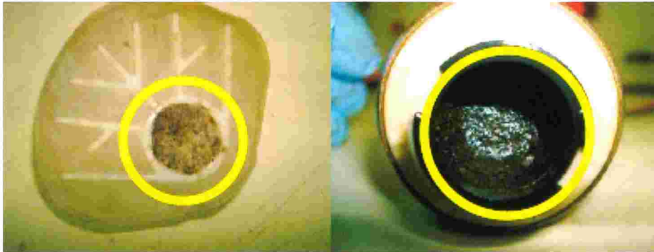
Figura 51: Resíduos nos filtros da bomba de combustível
