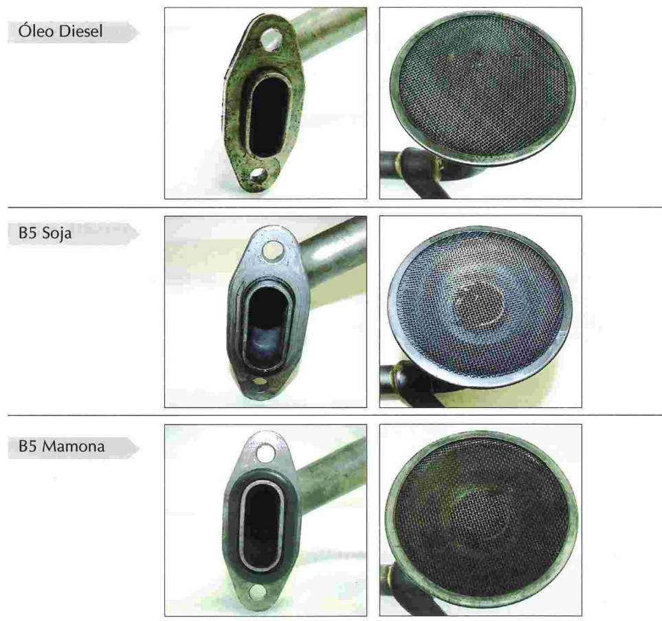
Figura 47: Tubo pescador de óleo combustível
