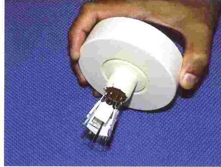
Figura 6. Língua eletrônica desenvolvida pelo CNPDIA.
