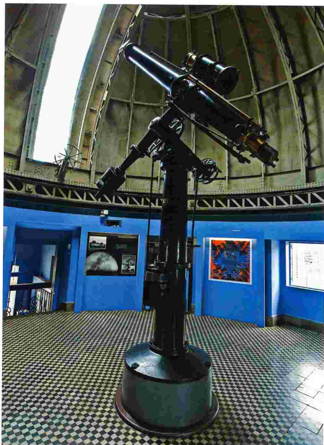
Luneta Equatorial 21 Gustav Heyde; Dresden, Alemanha Século XX (início) Distância focal: 302cm; diâmetro da objetiva: 20cm Utilizada para observações astronômicas PROCEDÊNCIA: OBSERVATÓRIO NACIONAL
