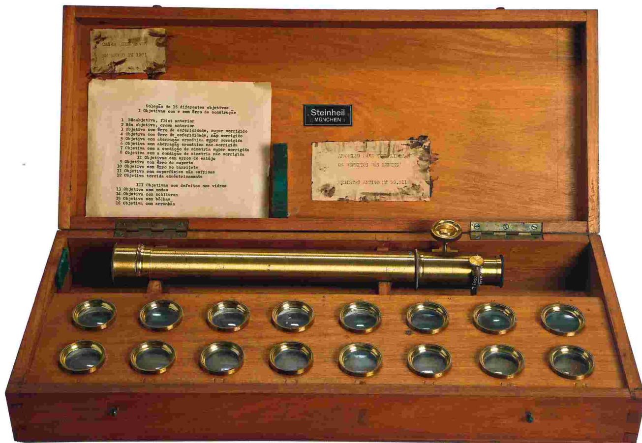
Instrumento para exemplificar defeitos de lentes Steinheil; Munique, Alemanha Século XX (início) (atribuição) | (8,5 x 48,5 x 19,0)cm Utilizado para demonstrar os vários defeitos óticos em lentes. PROCEDÊNCIA: OBSERVATÓRIO NACIONAL
