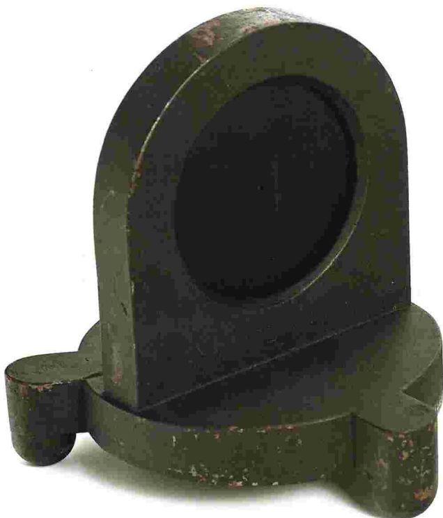
ABAIXO: Conjunto de miras Utilizadas como referência da observação, para controlar a orientação dos círculos meridianos. PROCEDÊNCIA: OBSERVATÓRIO NACIONAL
