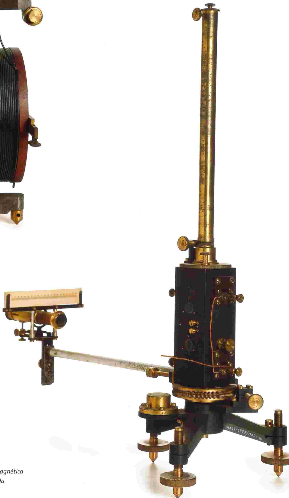
AO LADO: Magnetômetro Otto Toepfer & Sohn; Potsdam, Alemanha Século XIX | (48,0 x 44,5 x 17,0)cm Utilizado para medir a intensidade de um campo magnético (declinação e a inclinação magnéticas).
