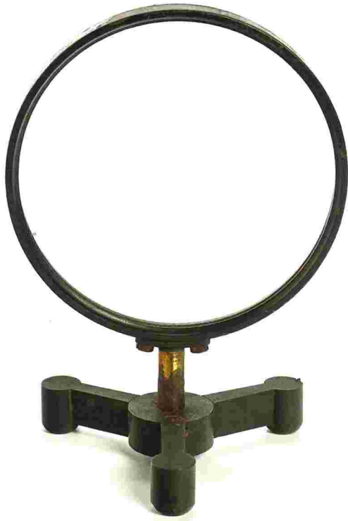
Lente (17,0 x 10,5 x 10,5)cm Utilizada nos sistemas óticos de instrumentos astronômicos para aumentar a distância visual possibilitando a leitura da escala da mira. PROCEDÊNCIA: OBSERVATÓRIO NACIONAL
